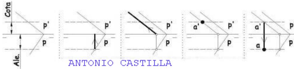
Por donde una de ellas toque a la traza del plano haces una perpendicular a la línea de tierra hasta que toque a esta. Y por ahí una paralela a la otra traza del plano.
