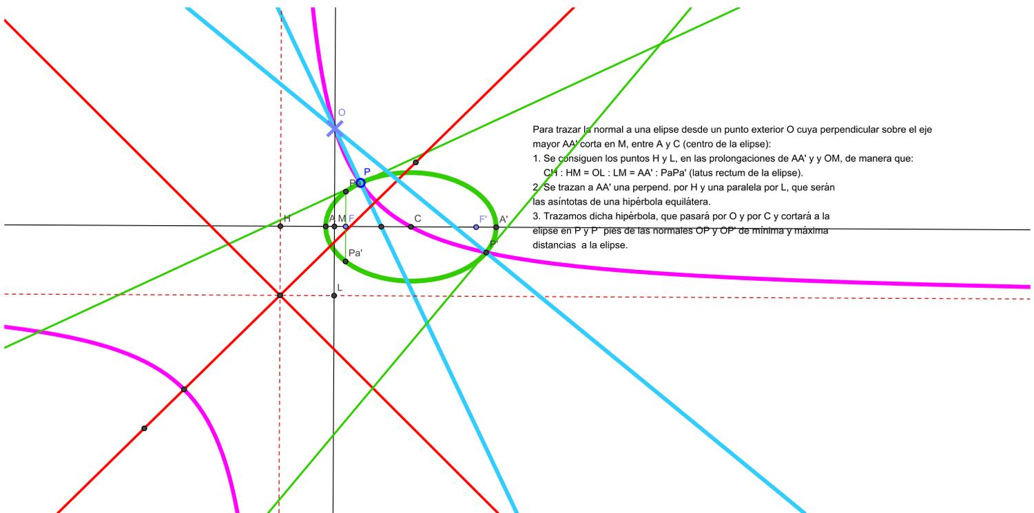
Para trazar la normal a una elipse desde un punto exterior O cuya perpendicular sobre el eje mayor AA' corta en M, entre A y C (centro de la elipse):
