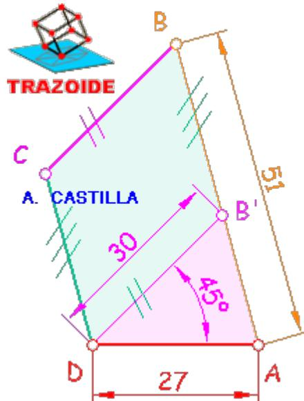
2 - Por el extremo D levantar una recta que forme el ángulo dado entre los lados no paralelos,  $45^\circ$ .
