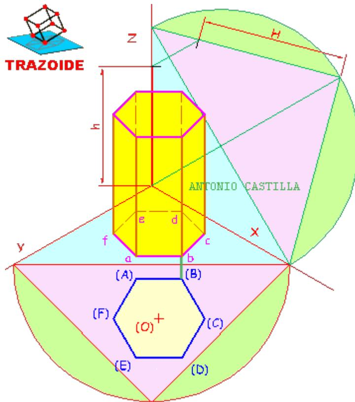
11 - El lado (A)-(B) es paralelo a la traza sobre la que se abate, por lo tanto, por a se hace una paralela a dicha traza y por (B) una paralela al eje Z, dando el extremo b
