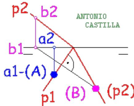
2 - Si un punto, B, esta en el plano vertical y además pertenece a un plano oblicuo, si abates alrededor de la traza horizontal del plano su abatimiento esta sobre la traza vertical abatida. A partir de su proyección horizontal, B1, dibuja una perpendicular a la traza horizontal del plano y donde corte a la traza vertical del plano abatida es el abatimiento del punto, (B).
