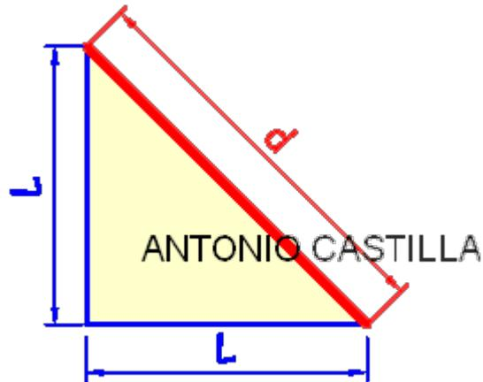
2 - Uniendo sus extremos se obtiene el valor de la diagonal de cara, d
