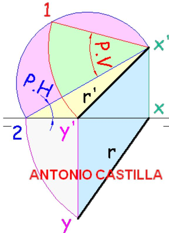
1b - Por  $x'$  se traza una recta que forme con la línea de tierra el ángulo dado para el plano horizontal de proyección (P.H)
