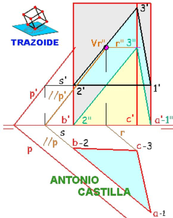
5 - Conocida la dirección de la traza vertical del plano,  $//p'$ , basta con hacer una paralela por el vértice del plano dado, obteniéndose la traza vertical del plano,  $p'$ .
