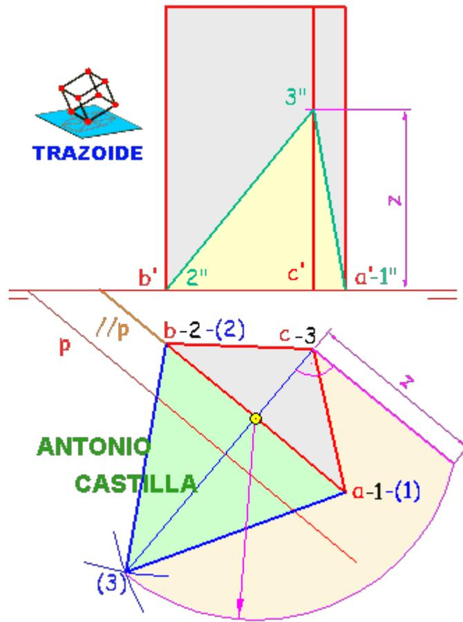
2 - Hagamos una traslación del plano que haga coincidir su traza horizontal,  $//p$ , con la proyección horizontal de AB. En ese caso, las proyecciones de los vértices 1 y 2 coinciden con la de los vértices A y B. Se realiza el abatimiento de la sección, de la que ya se conoce su verdadera magnitud (un triángulo equilátero), por lo que se dibuja este, (1)-(2)-(3).
