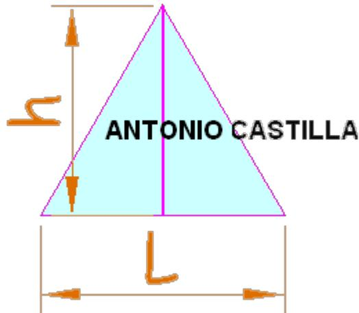
2 - Después se dibuja un triángulo isósceles con el valor de la altura de cara,  $h$ , (el lado que se repite) y la longitud del lado,  $L$
