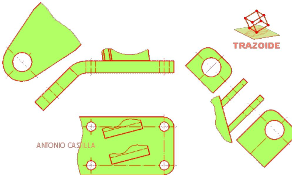
La planta nos da información sobre las medidas que no aparecen en el alzado, sobre la disposición de los cuatro taladros y la orientación de las orejetas. Pero la parte izquierda estaría deformada por lo que no se dibuja.
