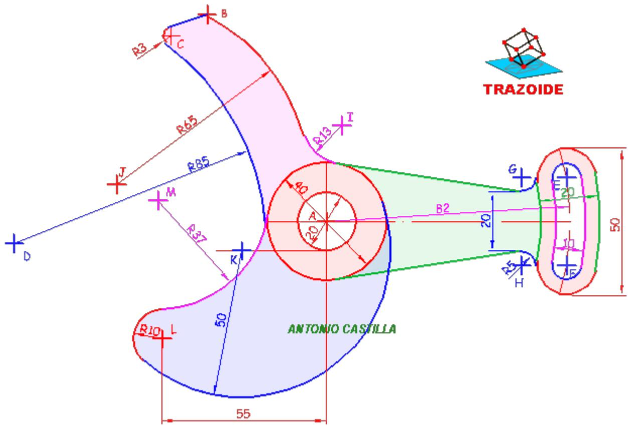
13 - Con centro en I y radio  $65 + 13$  hacer un arco. Desde el punto B hacer otro arco de radio 65. Donde ambos se corten es el centro J del arco de radio 65 mm
