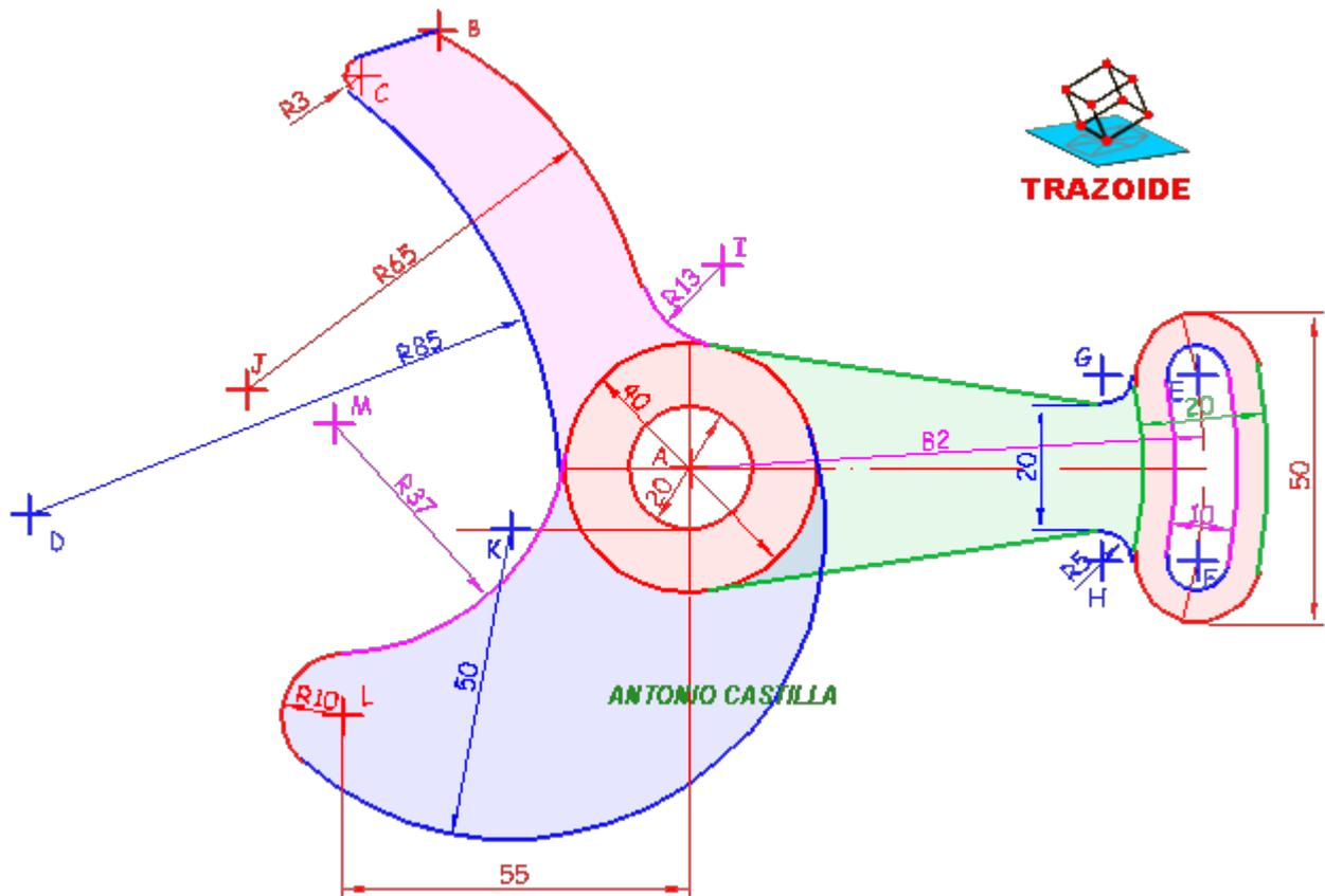
15 - Con centro en K y radio  $50 - 10$  hacer un arco. A partir del punto A hacer una paralela al eje vertical separada 55 mm. Donde corte al arco anterior es el centro L de radio 10 mm
